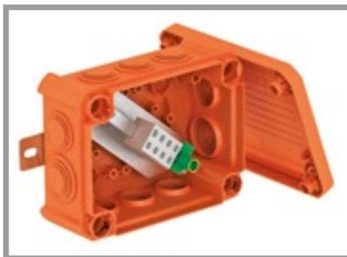
Распределительные коробки имеют предварительно смонтированную клеммную колодку из термостойкой специальной керамики. Предназначены для соединения кабеля номинальным сечением до 16 мм<sup>2</sup>.
