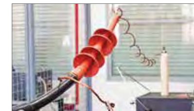
Высоковольтные испытания кабельных муфт
