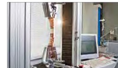
Испытания наконечников на разрывное усилие
