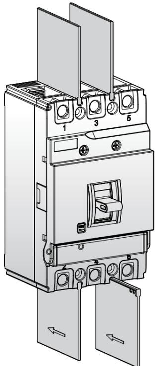
**Функция.** Межфазные перегородки служат для улучшения межфазной изоляции присоединяемых проводников.
