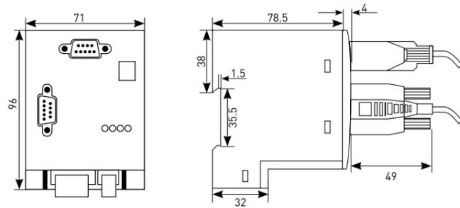
Изделие AV-DP устанавливается на стандартную DIN-рейку 35 мм. Положение в пространстве горизонтально или вертикально.
