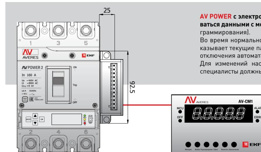
**AV POWER с электронным расцепителем ETU может обмениваться данными с модулем AV-CM1** (модуль индикации и программирования).
