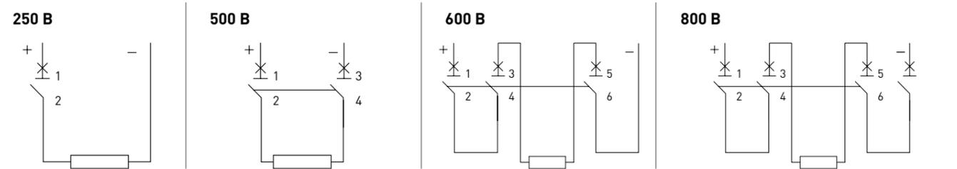
Анод и катод обязательно подключать в соответствующие клеммы автоматических выключателей. Сечение клемм: 1-32А 25 мм<sup>2</sup> и менее, 40-63А 35 мм<sup>2</sup> и менее.
