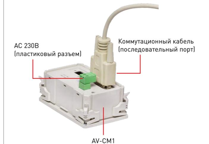
Пользователь должен подсоединить пластмассовый разъем к AC 230V. Вставьте подключенный пластмассовый разъем в порт с двумя жилами. Одну сторону последовательного порта подключить к порту DB9 на модуле дисплея, другую сторону последовательного порта подключить к модулю соединения.
