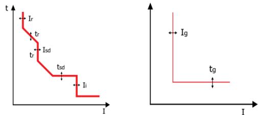
Перегрузка. Задержка по перегрузке.  $I_r$  — рабочий ток. Значение уставки  $I_r$  тока с допуском  $\pm 10\%$ .
