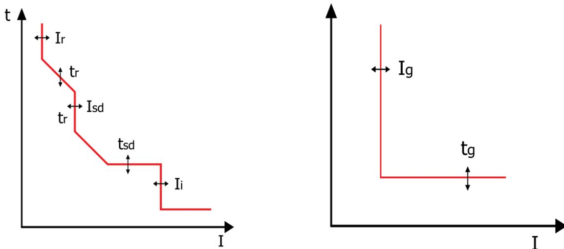
Ток перегрузки Ir. Задержка по перегрузке tr. Рабочий ток – значение уставки Ir с допуском ± 10%.
