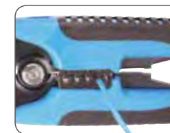
Опрессовка наконечника НШВ
