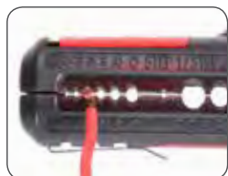
Снятие изоляции с проводов
