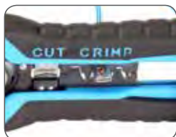
Опрессовка автоклепмы под двойной обжим
