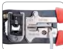
Зачистка круглого провода
