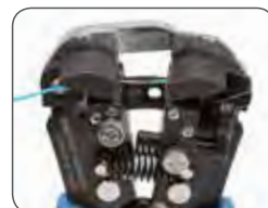
Снятие изоляции с микропровода
