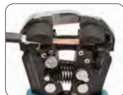
Одновременное снятие изоляции с трех проводов
