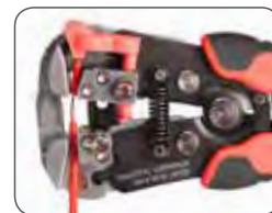
Снятие изоляции с проводов
