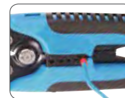
Опрессовка наконечника НШВИ
