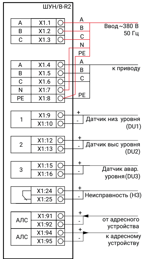
СХЕМА ВНЕШНИХ ПОДКЛЮЧЕНИЙ К ШУН/В-R2
