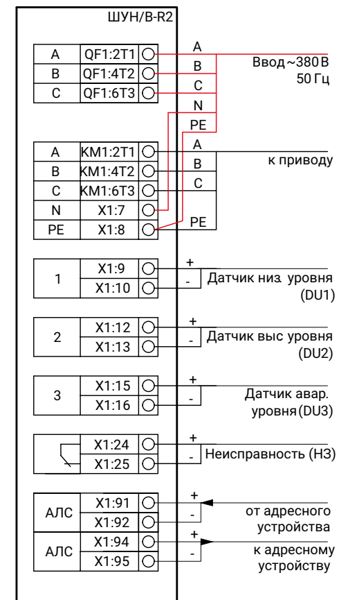
СХЕМА ВНЕШНИХ ПОДКЛЮЧЕНИЙ К ШУН/В-R2 на 18-45 кВТ
