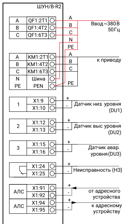
СХЕМА ВНЕШНИХ ПОДКЛЮЧЕНИЙ К ШУН/В-R2 на 55-110 кВТ
