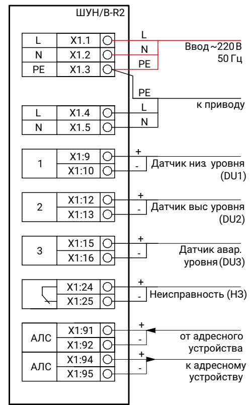
СХЕМА ВНЕШНИХ ПОДКЛЮЧЕНИЙ К ШУН/В-O-R2
