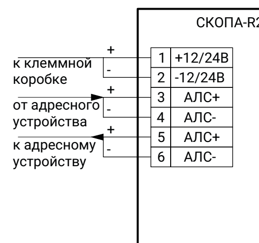
СХЕМА ПОДКЛЮЧЕНИЯ СКОПА-R2 К АДРЕСНОЙ ЛИНИИ СВЯЗИ
