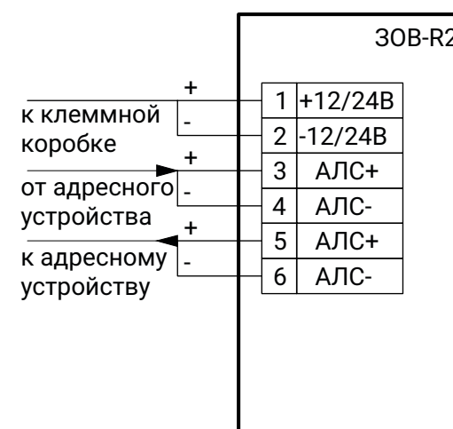
СХЕМЫ ВНЕШНИХ ПОДКЛЮЧЕНИЙ К ЗОВ-R2
